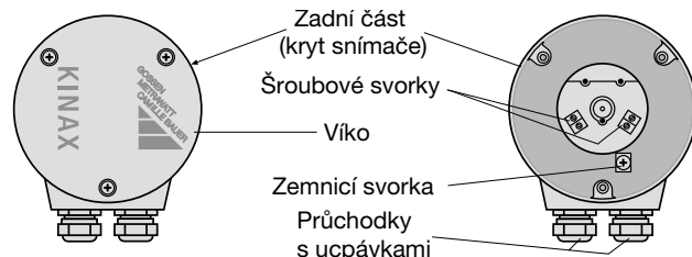
Obr. 9 KINAX WT 707 se šroubovými svorkami a průchodkami s ucpávkami
