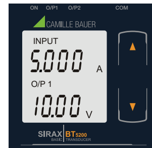
Anzeige 3: Strom- Eingang und Ausgang 1 als Spannung
