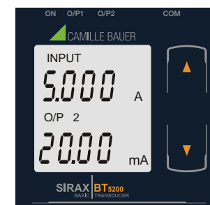
Anzeige 6: Strom- Eingang und Ausgang 2 als Strom
