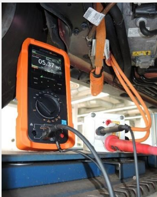
Zkouška izolace pomocí METRAHIT IM E-DRIVE ve vysokonapěťovém okruhu vozidla (GOSSEN METRAWATT)
