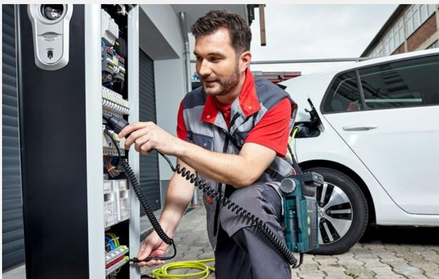
Zkouška elektrické bezpečnosti pomocí PROFITEST MXTRA (GOSSEN METRAWATT)
