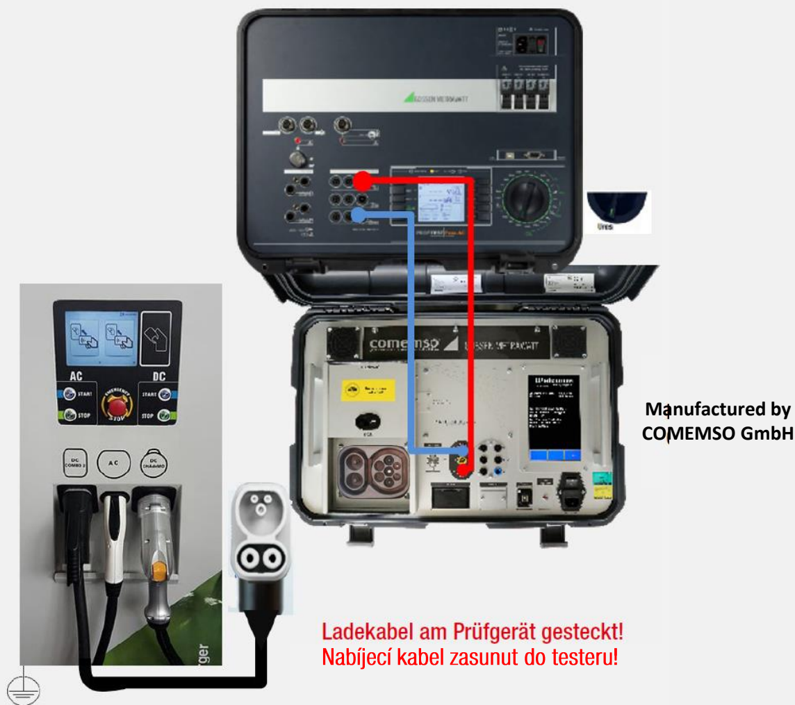
Obr. 3. Měřicí sestava u DC nabíjecí stanice s PROFITEST H+E XTRA a PROFITEST PPRIME
