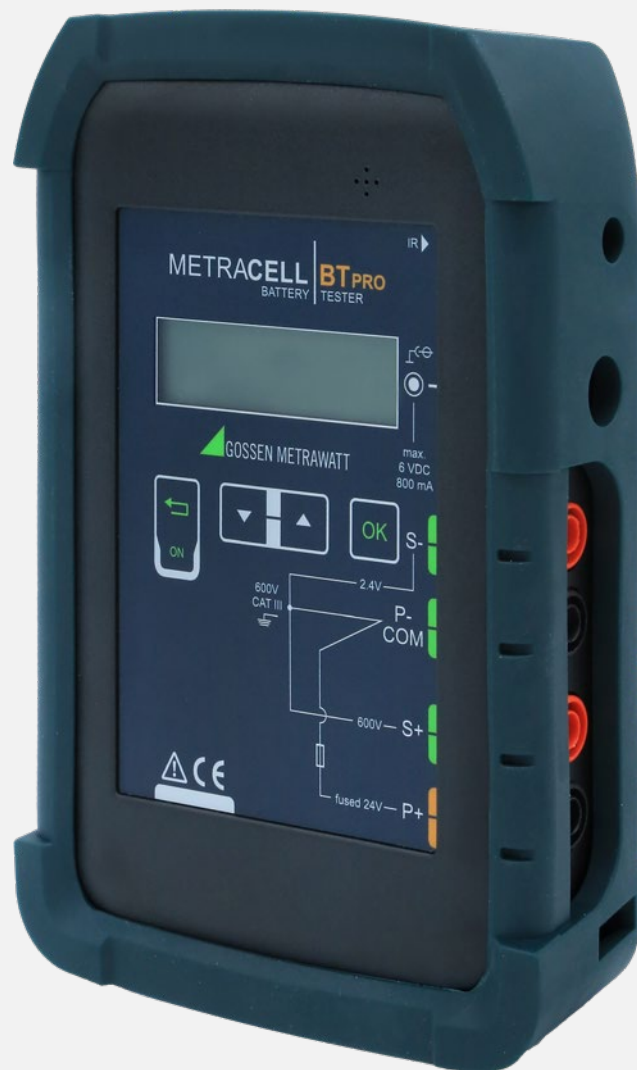
Obr. 2. Pomocí Metracell BT PRO lze vedle testu kapacity vybíjením a intervalových zkoušek provádět různé zkušební postupy bez vybití článku
