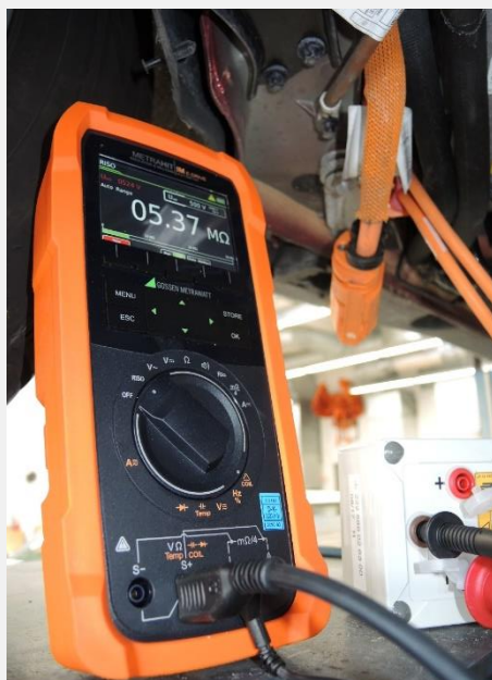
Obr. 12. Kontrola izolačního odporu zkušebními napětím 500 V mezi invertorem a zemí pomocí měřicího adaptéru na konektoru Rosenberger na příkladu vozidla Mercedes GLC 350 e
