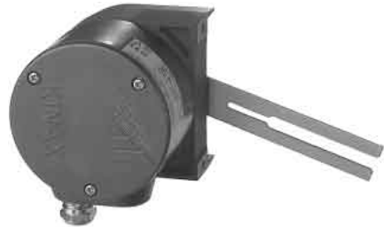
Obr. 1: Hlásič polohy KINAX SR 719, připojovací páka v klidové poloze směřuje dolů; tomu odpovídá výstupní proud 4 mA.
