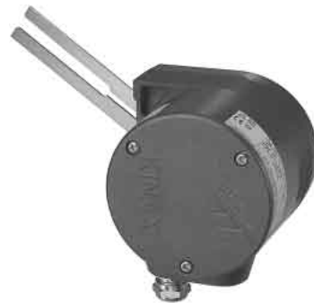
Obr. 2: Hlásič polohy KINAX SR 719, připojovací páka v klidové poloze směřuje nahoru; tomu odpovídá výstupní proud 4 mA.
