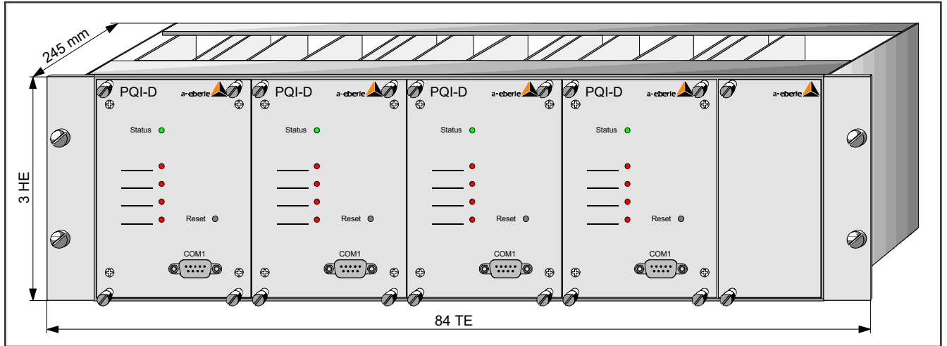
Obr. 6: montážní skříň 19" (kód B9) osazená 4 kusy PQI-D (kód B1)
